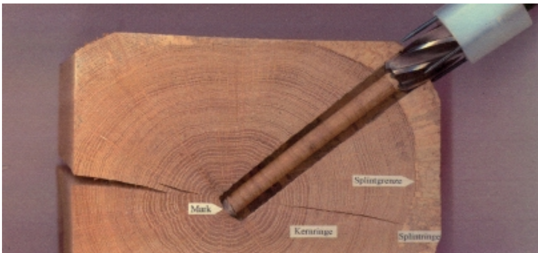
Abb. 7: Entnahme eines Bohrkerns aus einem Eichenstamm (Foto: Preßler)
